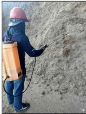
รูปที่ 26 การฉีดพรมน้ำที่ผสมสารฆ่าเชื้อราบริเวณลานกองขานอ้อย
