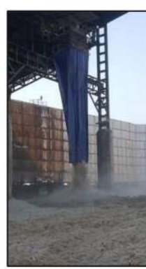
รูปที่ 5 อุปกรณ์ครอบป้องกันการฟุ้งกระจายบริเวณปลายสายพานลำเลียง ณ จุดโปรยขานอ้อยลงสู่ลานกองเก็บขานอ้อย
