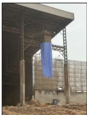
รูปที่ 5 อุปกรณ์ครอบป้องกันการฟุ้งกระจายบริเวณปลายสายพานลำเลียง ณ จุดโปรยขานอ้อยลงสู่ลานกองเก็บขานอ้อย
